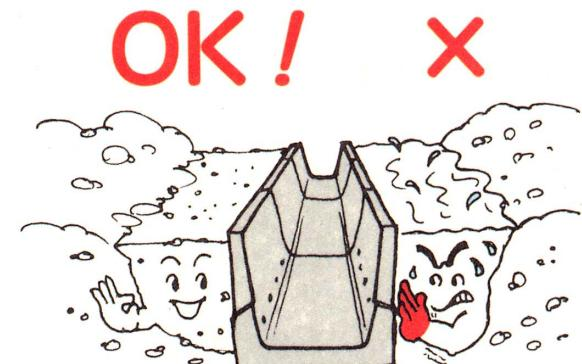
水分を多量に含んだ泥土を埋めもどしに使うと、土圧が設計より大きくなり、フリュームを破損することになります。できるだけ乾いた固い土砂を使うようにして下さい。
