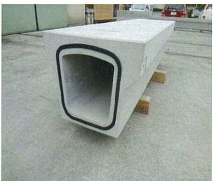
③ゴムパッキンの取付
